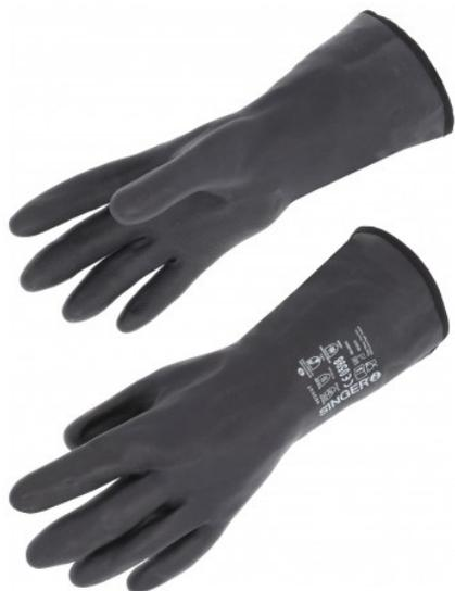
GANT DE PROTECTION MULTI-RISQUES EN POLYCHLOROPRÈNE SUR SUPPORT PEHD. Support: polyéthylène haute densité, tricoté une pièce. Jauge: 10. Manchette: bord droit avec liseré. Longueur: 370 mm (valeur moyenne). Epaisseur: 1,70 mm (valeur moyenne). Enduction: polychloroprène, tout enduit. Finition extérieure: lisse (manchette et dos) et gaufrée (paume). Coloris: noir
